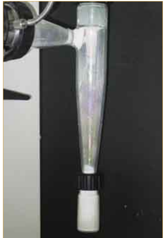
図3 小型回収サンプル容器とガラスエルボーを備えた高性能サイクロン。このサイクロンは全タイプのビュッヒミニスプレードライヤーに取付け可能
