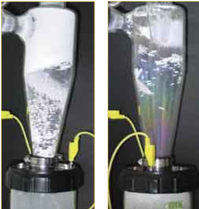
図2. a) 非コーティングサイクロン： 内壁上にサンプル損失 b) コーティングサイクロン： サンプル付着が少ない
