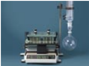
シンコア・ポリバップ 多検体を同時に濃縮・蒸留
