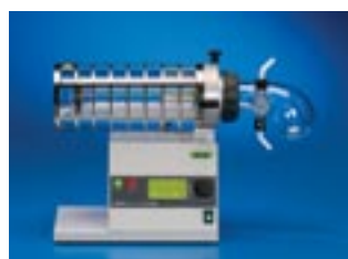
ガラスチューブオープンB-585TO コンパクトな乾燥器
